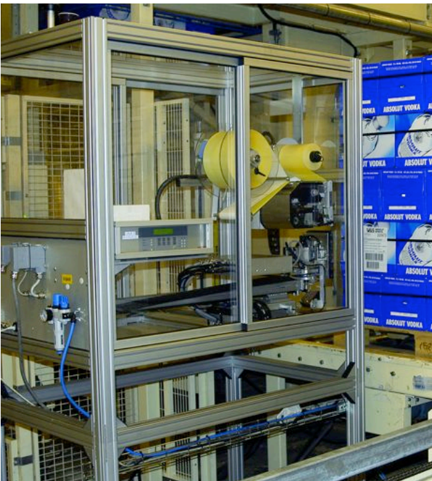
Aplicador de palets M600 con lector verificador de códigos de barras
